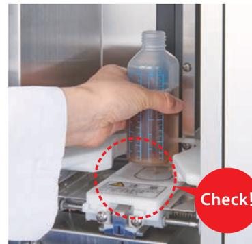
分注量は、投薬瓶セット部の天秤ユニットで確実にチェック。分注後に各薬品の秤取量鑑査ができない水剤調剤には必須の機能です。
