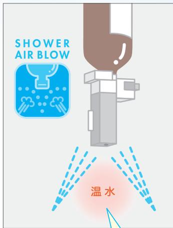
洗浄水を機器内で60℃前後に温めてノズルを洗浄。
