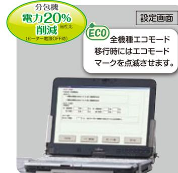
ヒーターローラーは90℃(約10%以上削減・復旧時間約3分)と完全OFF(約20%以上削減・復旧時間約6分)のモードが選択できます。
