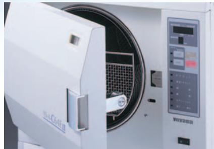
自動ドアロック機構により、誰でもワンタッチで確実な扉の開閉を行えます。運転中は残圧時扉開放防止装置の働きで、操作ミスや、万一ガス充満中の誤作動が起こった場合にも、扉が開きませんのでガス漏れを防ぐことができ安心してお使いいただけます。※C64EJIIのみ
