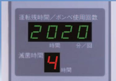
ドアロック・真空・ガスイン・滅菌・置換・エアレーションの各工程の情報をモニターに表示。全工程の終了時間を分かりやすくカウントダウンします。また、ガスイン開始時と終了時には安全対策として元バルブの開栓と閉栓を知らせる、警告音を鳴らします。
