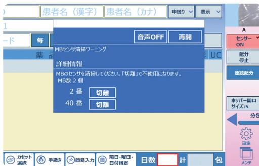
使用による汚れが発生すると、自動で検知し清掃を促すワーニング表示機能を標準搭載。汚れによるセンサー異常リスクを未然に防ぎ、安心してお使いいただけます。
