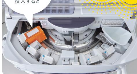
フィーダー部に計量可能なロードセルを設置、散薬カセット内の実在庫量をソフトで管理しています。もしセットした散薬カセットが記憶している重量と異なる場合アラートを表示させ、動作を開始しません。万が一のリスクも回避でき、安心して操作が可能となります。PAT.P
