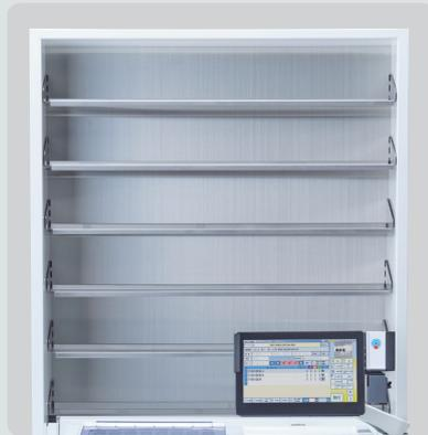
専用の散薬カセットを最大90コ設置できる棚6段タイプと、最大26コ設置できる棚2段タイプ。あらゆる散薬一包装処方に対応可能です。
