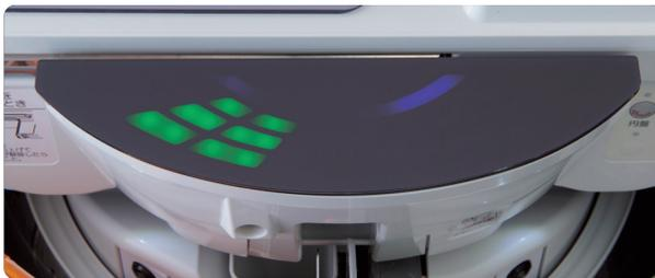
新型パネルにはLEDによるインジケーターで、配分の進捗具合をわかりやすく表示します。配分開始時は濃く表示されているインジケーターが、段々と薄く変わり、配分が終わると表示が消えていきます。
