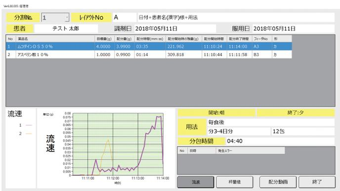
秤量した結果を履歴で確認することができます。特に流速グラフを確認することで、カセット内から散薬の固まりが落下していないかどうかまで推論可能です。
