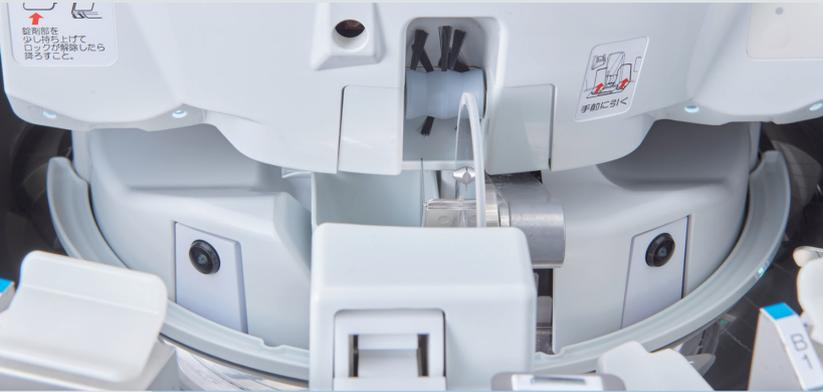
分包完了後、重曹をR円盤・スクリュー・ホッパーといった散薬経路すべてに通して自動清掃を行います。
