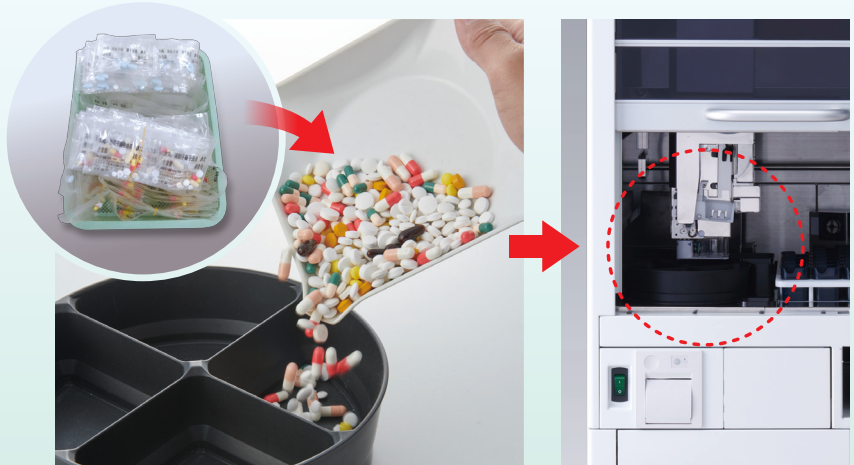
未使用の一包装された錠剤をほどき、まとめて専用トレイへ。
