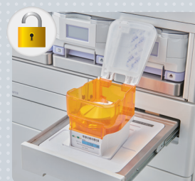
照合OKでフタロックが解除 ※フタの開閉は手動です
