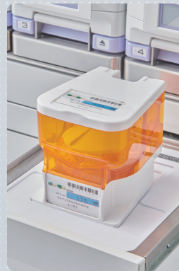
RFIDで錠剤カセット認識 PAT.
