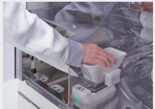
手差しフィーダーを容易にセット可能(LED点灯部)
