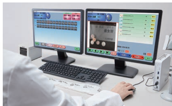
2つのモニターで、判定結果一覧と薬包ごとの詳細画像を同時に確認することができます。
