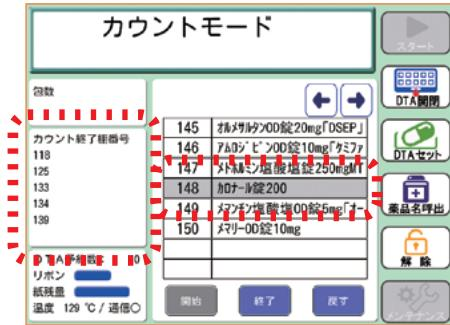
カウントが完了したカセットNo.が表示され薬品名がグレーになります!
