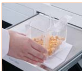
充填テーブルにカウントカセットをセット
